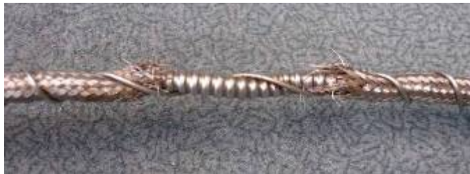
Typisches Ergebnis eines Wegfahrunfalls - beschädigtes Equipment
