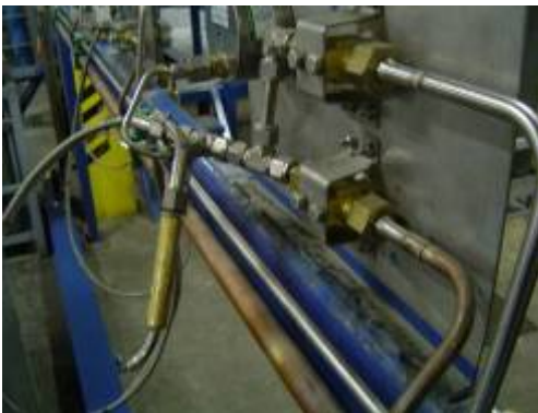
Typisches Ergebnis eines Wegfahrunfalls - beschädigtes Equipment
