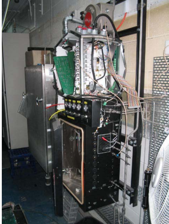
Foto des GC nach der Explosion
